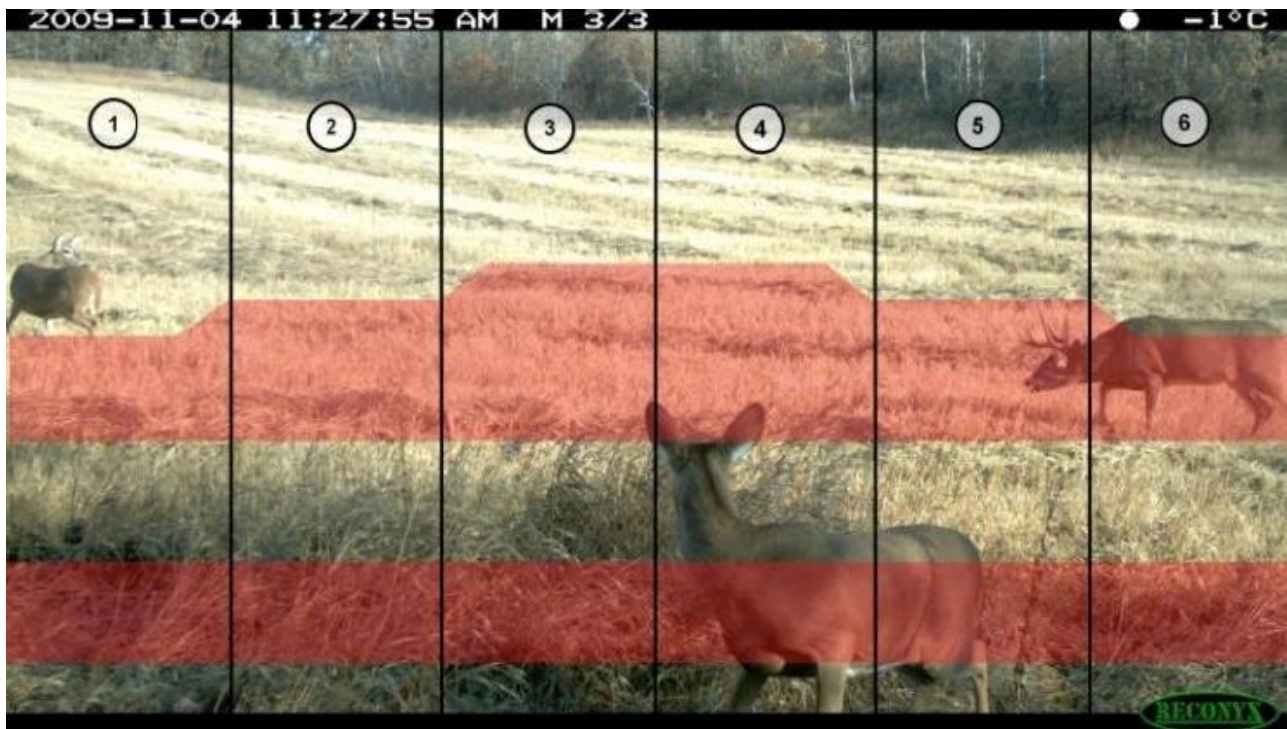
Abb. 1: Sensorbereich (sechs Sektoren) der Kamera Hyperfire. Abbildung entnommen aus RECONYX (2010). Die beiden Tiere rechts würden, wenn sie sich bewegen, unabhängig voneinander die Kamera auslösen. Das Reh links im Bild nicht, da es sich oberhalb der Sensorzone befindet.
